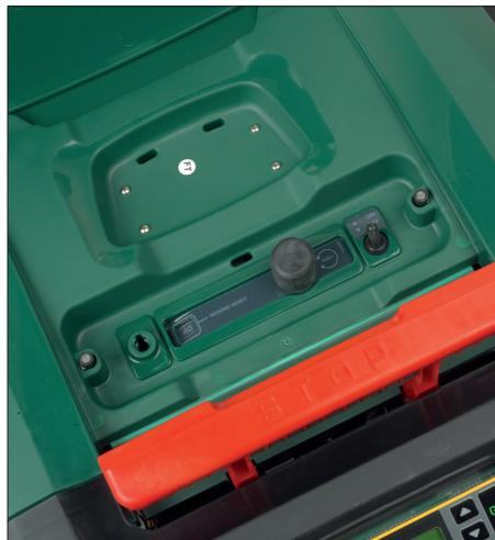
Die Schnitthöhenverstellung erfolgt zentral mit Hilfe eines Einstellknopfes
