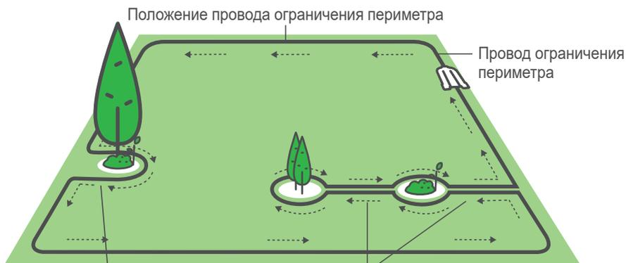
Если расстояние между островком и проводом ограничения периметра меньше 1,2 м, сделайте это препятствие частью края газона.
