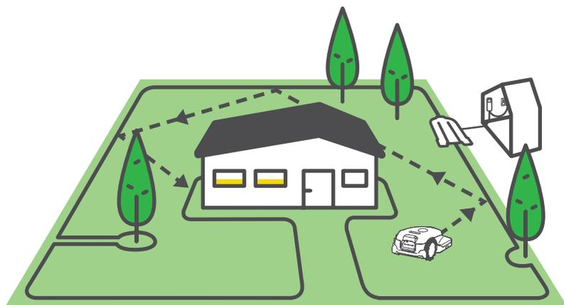
Косилка передвигается по рабочей зоне случайным образом, не выходя за рамки, установленные проводом ограничения периметра. Случайное перемещение обеспечивает идеальную стрижку всего вашего газона.
