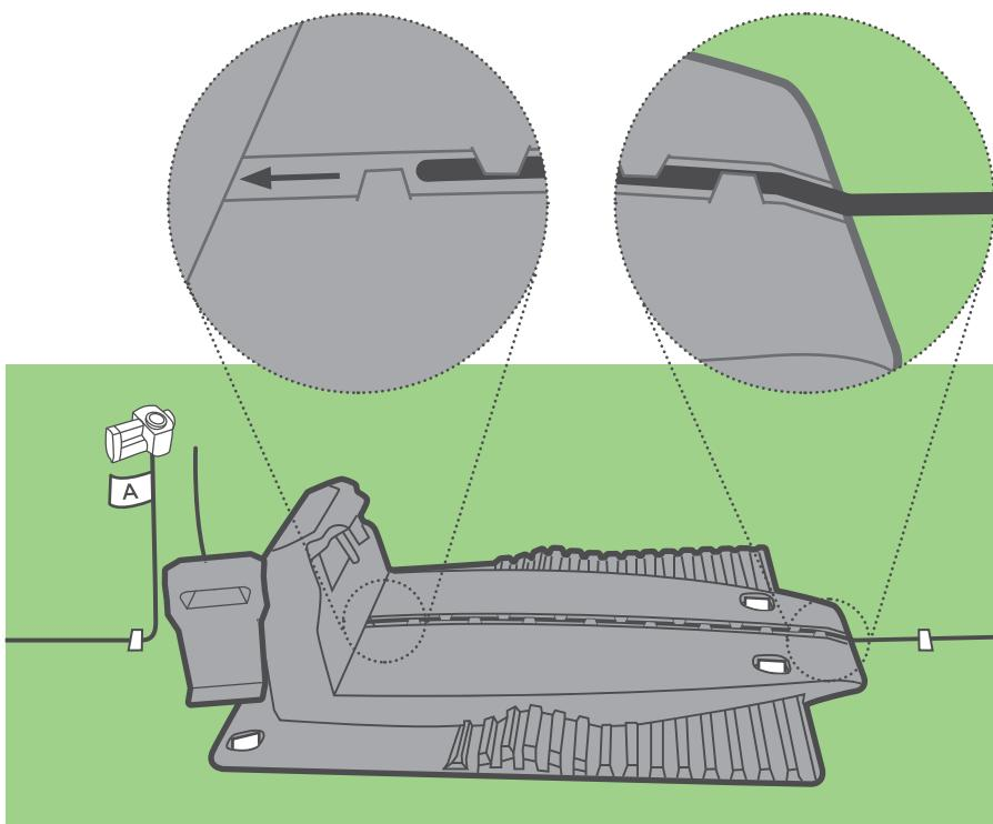
Installer kontakten på enden av ledningen som beskrevet på tegningene. Klipp ledningsenden, nær kontakten.
