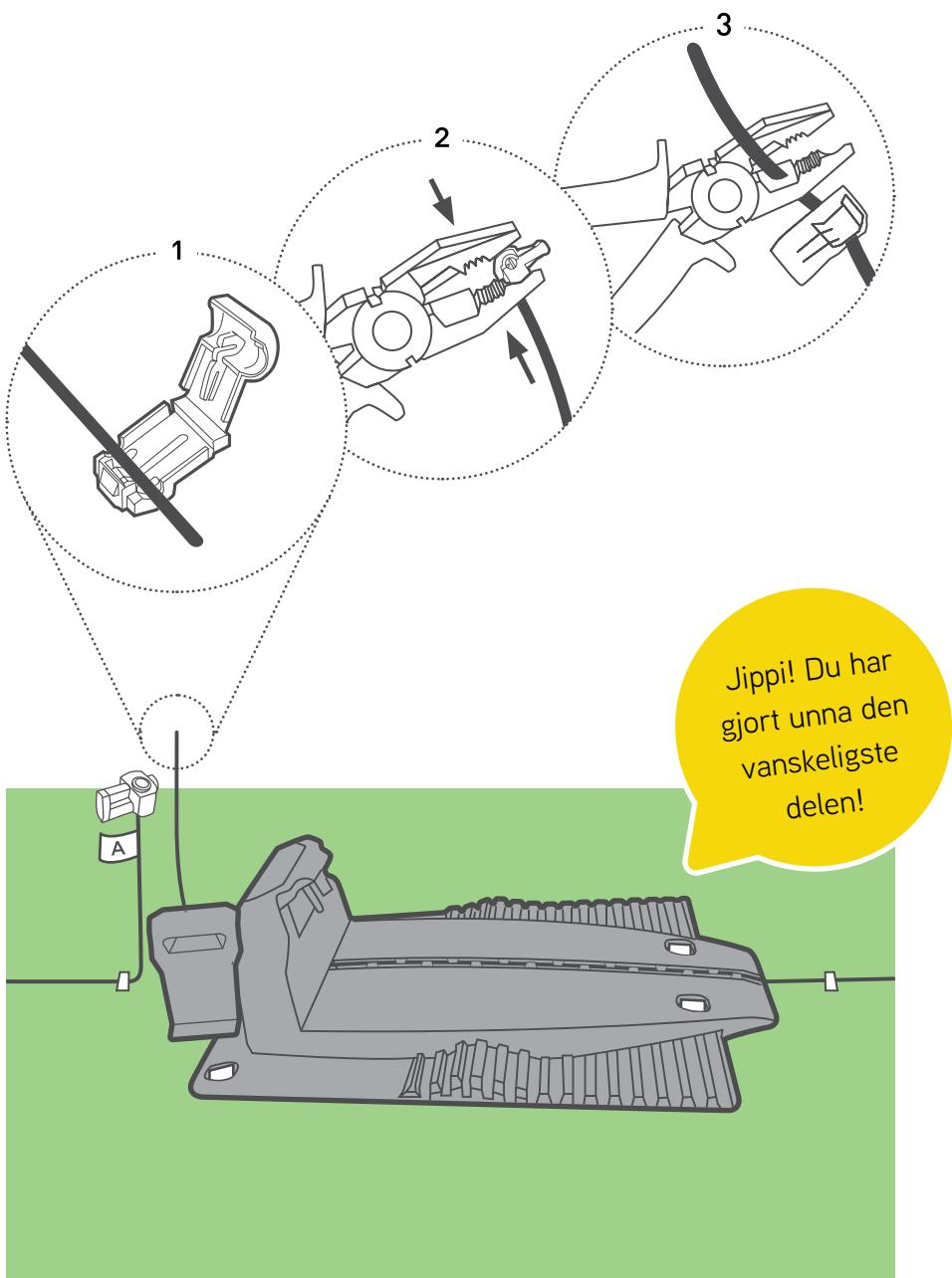
Plugg ledningen til bakken. Vri og vikle ledningene slik at de passer fint inn i ladestasjonen. Koble ledningsenden merket med "A" til kontakten merket med A på baksiden av ladestasjonen. Koble den andre enden til den andre kontakten. Stikk ledningen inn og lukk døren.
