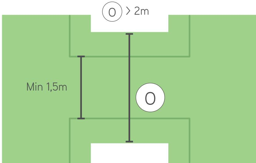
Når en smal passasje er mellom 1-2 m (3-6 fot), bør ledningene installeres midt på passasjen med RoboLinjal avstand 1 mellom dem, slik at gressklipperen kan følge ledningene inn og ut av delsonen. Ved inngangen til stien fra begge retninger bør du bryte hjørnet til 45 grader slik at klipperen svinger nøyaktig inn og ut fra delsonen.
