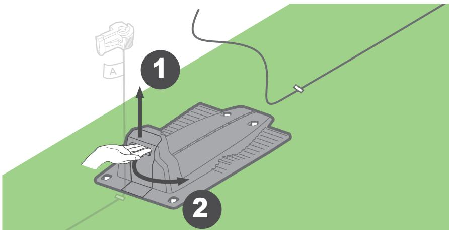
Skyv eller installer ledningen gjennom den eksisterende tunnelen og før den gjennom åpningen under ladekontaktene til den går ut på baksiden av ladestasjonen.
