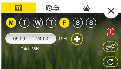
La cortadora de césped dejará de cortar una vez que haya alcanzado las horas requeridas para la semana según el tamaño del césped, así que no piense que este horario es necesario para evitar que la cortadora de césped trabaje demasiado.
