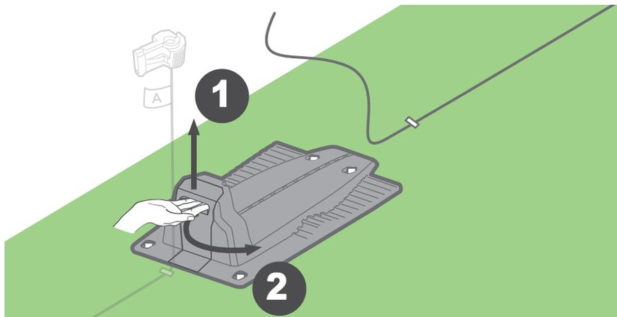
Deslice o instale el cable a través del túnel designado y páselo por la abertura debajo de los conectores de carga, hasta que salga a la parte trasera de la estación base
