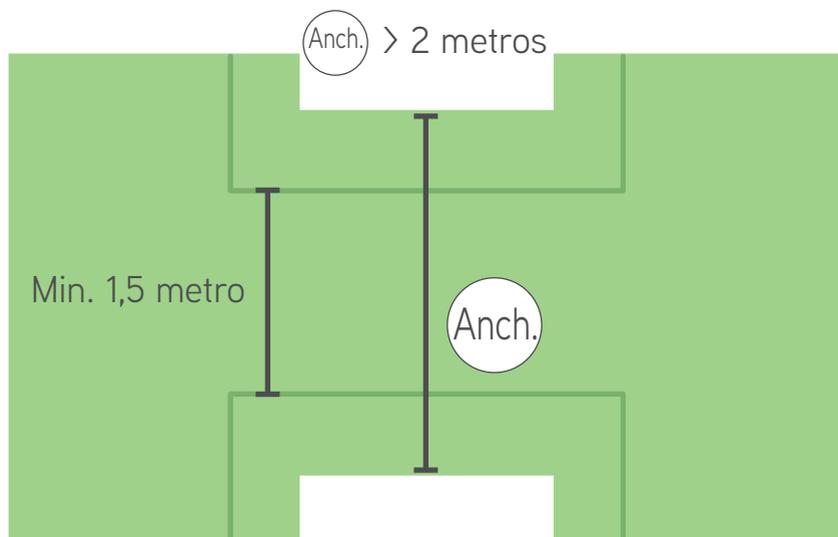
Cuando la anchura de un paso estrecho es de 1 a 2 metros, los cables se deben instalar a medio camino con la distancia 1 del RoboRuler entre ellos, de modo que la cortadora de césped pueda seguir los cables dentro de la subzona y fuera de ella. En la entrada al camino desde ambas direcciones, debe doblar la esquina a 45 grados, de modo que la cortadora de césped gire con precisión dentro y fuera del paso estrecho.
