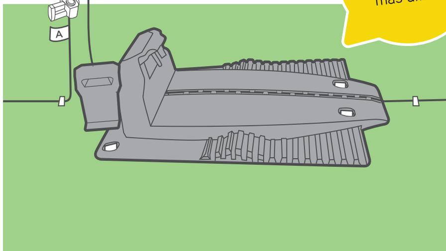
Con la estaquilla, clave el cable en la tierra. Retuerza y envuelva los cables para que encajen bien en el compartimento de la estación base. Conecte el extremo del cable marcado con una «A» al conector marcado con «A» en la parte posterior de la estación base. Conecte el otro extremo al otro conector. Introduzca el cable y cierre la puerta.
