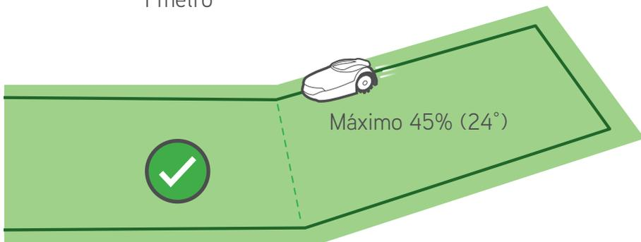
Excluya toda pendiente superior al 20% que se encuentre en el borde del césped, para evitar que la cortadora de césped se deslice fuera de él, en particular en condiciones de humedad
