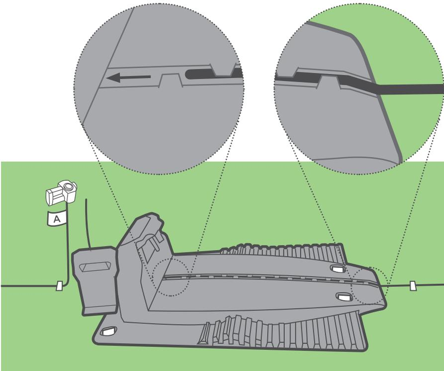
Bringen Sie den Verbinder gemäß Abbildung an der Drahtspitze an.
