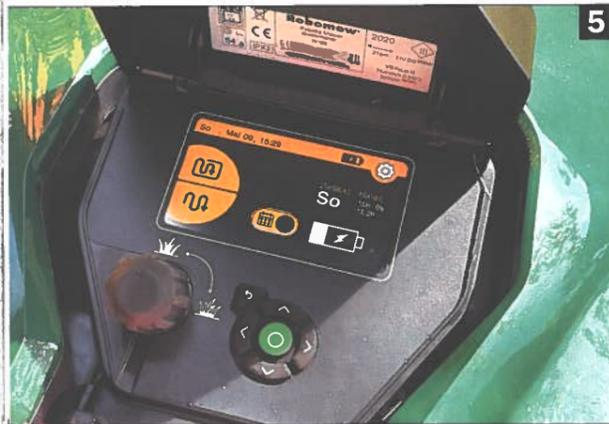
**5** (5) Luxus pur: Das Display des Robomow ist gleichzeitig das Bedienfeld zur Programmierung des Mähroboters
