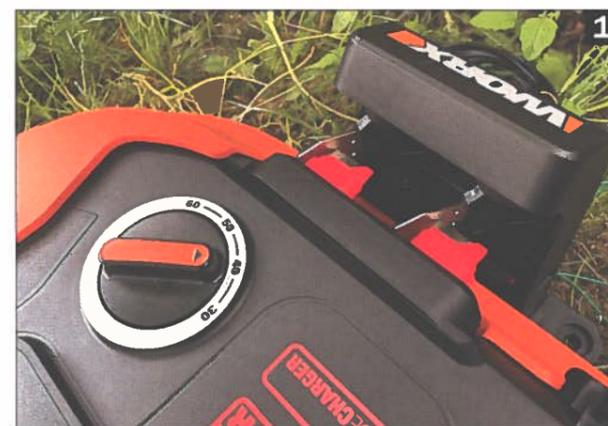
**1** Während der Einhell und der Robomow vorn in die Basis einparken, sind die Ladekontakte beim Worx und dem Al-Ko an der Seite platziert
