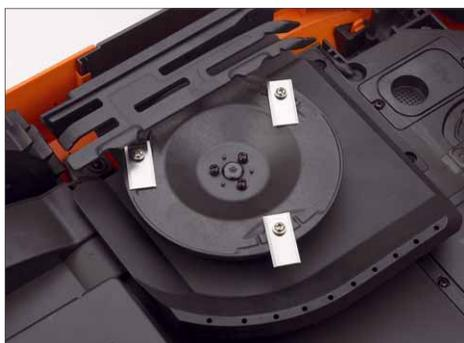
Als einziges Gerät im Testfeld ist das Mähwerk des Landroids seitlich versetzt montiert, sodass das Gerät recht präzise am Rand entlang mähen kann
