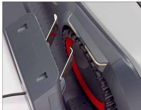
Der Robolinho ist ein „Seitenlader“, das heißt, die Ladekontakte finden sich an der Seite der Maschine, der Roboter kann zum Laden quasi durch die Station fahren, die unmittelbar am Rand des Rasens stehen soll
