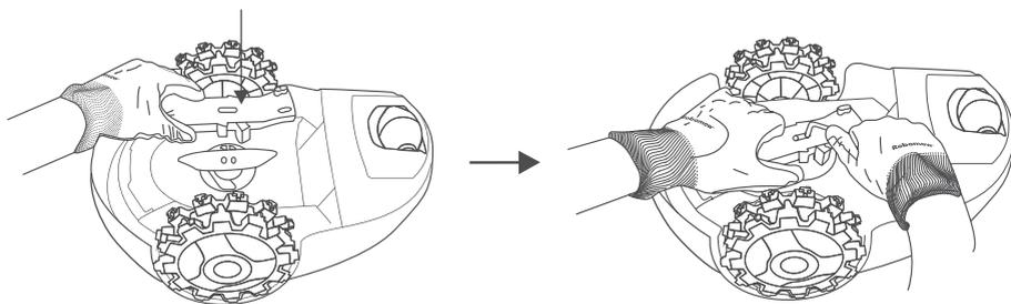
4. Utilisez la clé Allen (fournie avec la lame de rechange) et desserrer les vis tout en tenant la lame avec le RoboTool.
