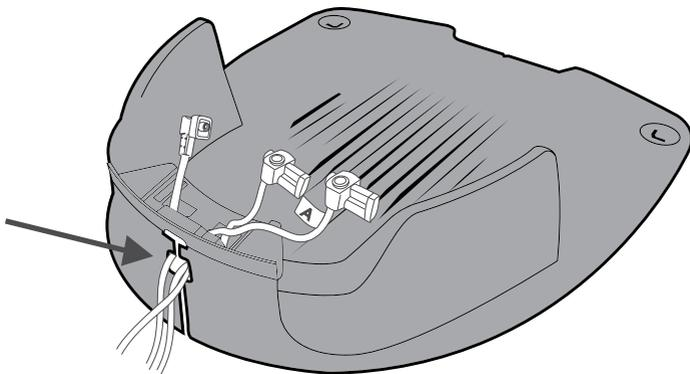
2. Connectez l'extrémité de câble repérée par A à la borne A et l'autre extrémité à la borne B de la tête de la station de base.
