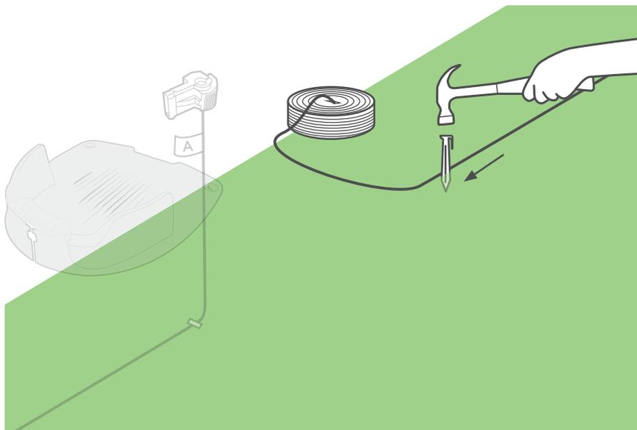
Faites en sorte que les deux extrémités du câble soient de même longueur. Utilisez une pince coupante pour couper le câble restant. Ne laissez pas traîner de câble enroulé
