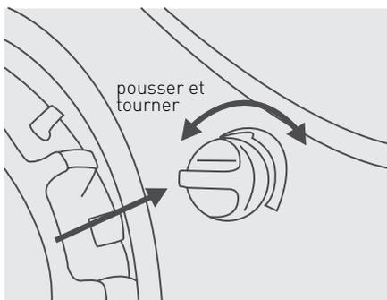
Pour régler la hauteur de coupe, poussez et tournez sur la poignée de réglage dans la direction souhaitée :
